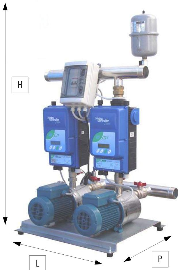
Gruppo di sollevamento acqua composto da elettropompe multistadio orizzontali inox, regolatori di velocità a frequenza variabile (inverter), raccorderia inox/ottone, vaso espansione l. 2.
